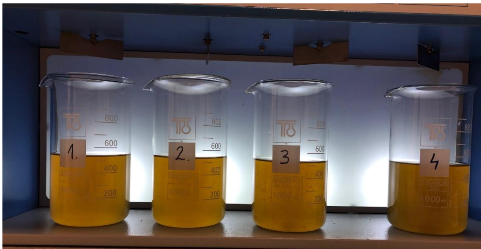
Slika 2.11. Proces flokulacije u JAR uređaju
