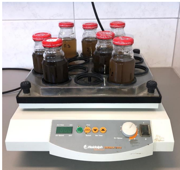
Slika 2.12. Prikaz adsorpcije aktivnim ugljenom
