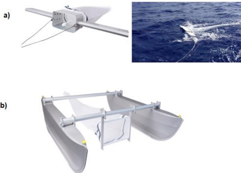
Slika 16. a) prikaz plankotnske mreže, "manta trawl", b) Neustonov katamaran [34, 35]
