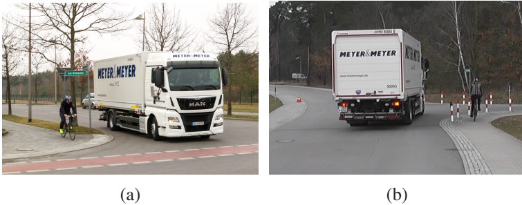
Abbildung 9.5: Durchführung der Tests im realen Szenario: Der LKW versuchte, bei der Kreuzung rechts abzubiegen, wobei gleichzeitig ein Fahrradfahrer entlang der rechten Seite vorbeifuhr. (a) zeigt ein schwierigeres Szenario als (b), da der Fahrradfahrer durch die Bäume zwischen dem Radweg und der Fahrbahn teilweise verdeckt ist.
