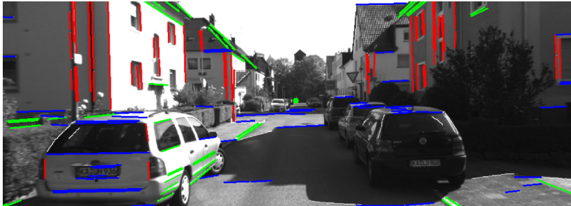
Abbildung 6.2: Kamerabild mit Linien aus Grauwertkanten, welche Fluchtpunkten zugeordnet sind. Grüne Linien sind dem in Grün gezeigten Fluchtpunkt zugeordnet, welcher auf dem Horizont liegt. Rote Linien sind dem vertikalen und blaue Linien dem horizontalen Fluchtpunkt zugeordnet, welche außerhalb des Bildes liegen. Der vertikale Fluchtpunkt beschreibt die Bodenebenennormale.
