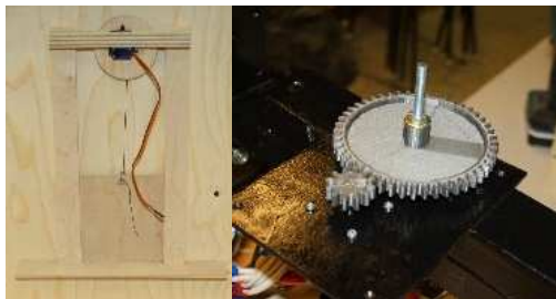
2. ábra: Az ajtónyitó mechanika és az áttétel
