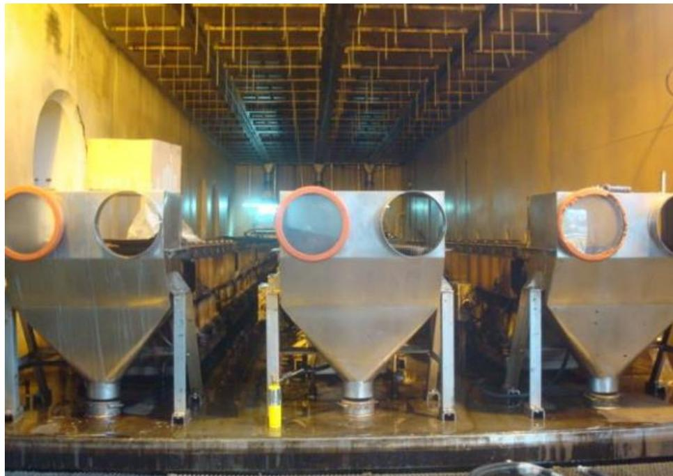
*Figura 13.* Vista de las tres líneas de secado de producto al interior de la cámara de vacío
