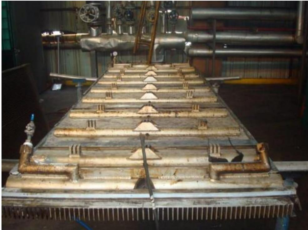
*Figura 14.* Conexiones de alimentación de vapor y descarga de condensado de una bandeja de secado
