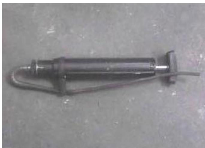
Figura 3. Equipo utilizado para medir el índice de Bacharach.
