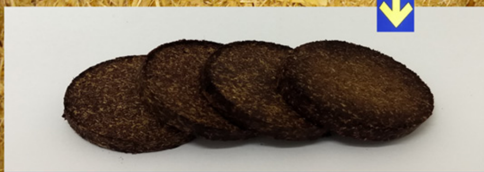
Placas de fibra de média densidade (MDF) a partir das fibras e da lignina do bagaço da cana-de-açúcar
