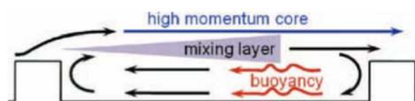
Figure 4.46 – Modèle schématique de l'effet de la flottabilité sur l'écoulement dans l'espace inter-perturbateur par Coletti et al. [26].
