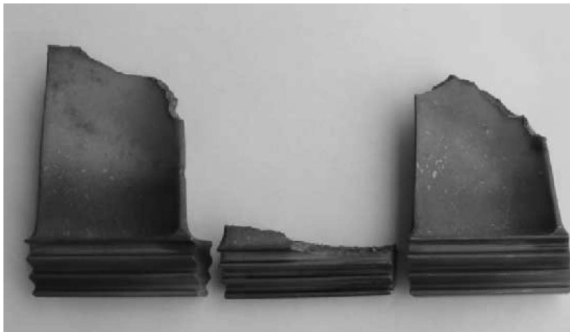
Figure 1.4 – Casse de pales de turbine due à une exposition à une chaleur trop importante d'après M. Park [133].
