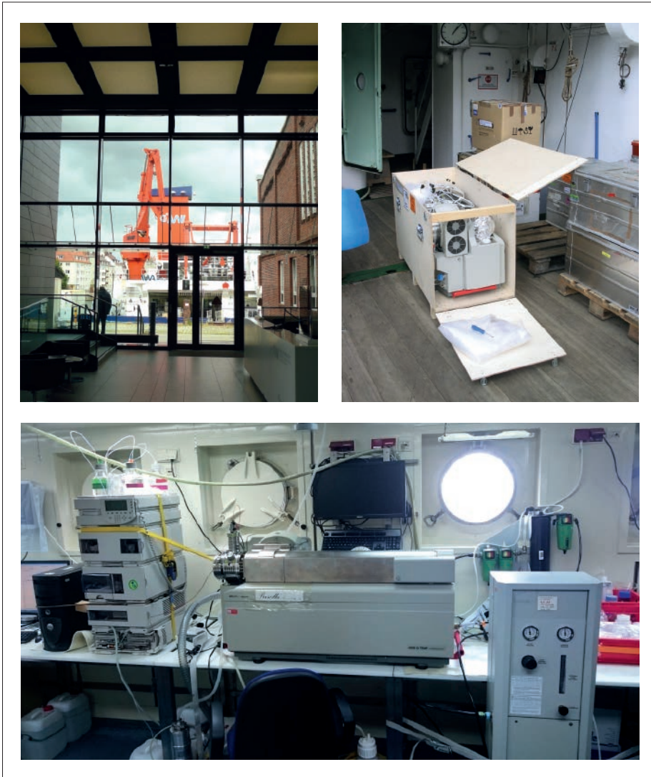
Abb. 2: Das Forschungsschiff Heincke an der AWI Pier (oben links), Triple Quadrupol Massenspektrometer beim Entpacken aus der Transportkiste an Deck (oben rechts) und das installierte LC-MS/MS im Schiffslabor (unten).
