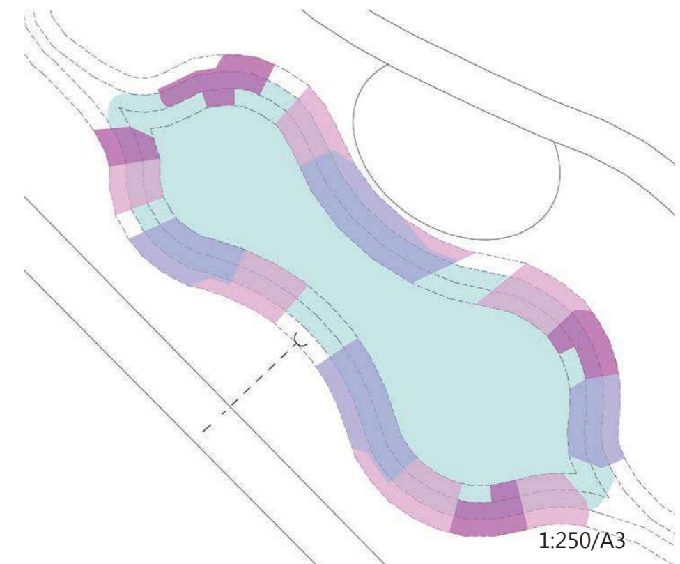
Bild 50. Översiktlig planeringsplan för lilla dammen. Färgkod för de tre olika principsegmenten som i bild 49. Reglerad normalvattenyta visas i blått.
