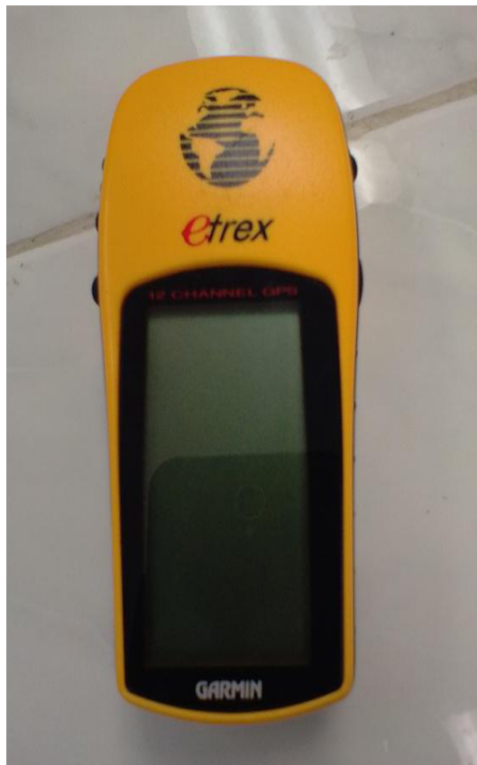
Figura 10. Instrumento GPS utilizado para realizar las mediciones de altitud.
