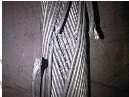
(d) Wire failure modes for V_i = 360 m/s
