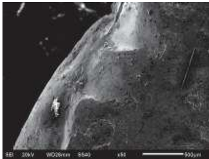
(d) Edge region: V_i = 580 m/s (SEM 50 x mag.)
