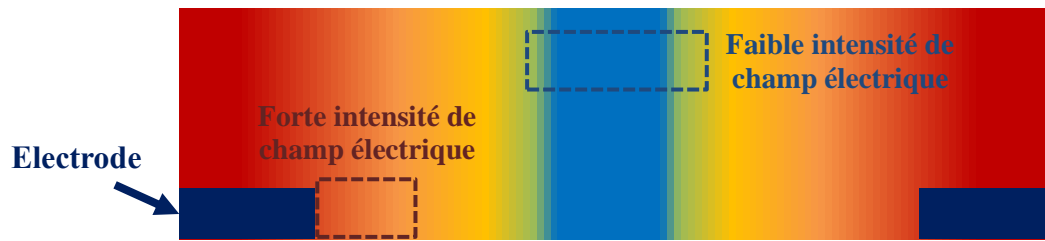
Figure. 95 Schéma illustrant le gradient de champ électrique à générer sur une section du canal microfluidique, puis à maintenir tout le long de celui-ci.
