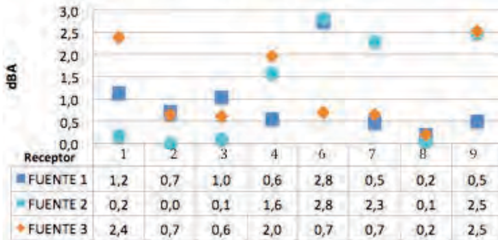
Fig. 5.17 "Gráfica de valores de eficiencia lateral media de simulación de caracol sin audiencia". Elaboración propia, 2014.
