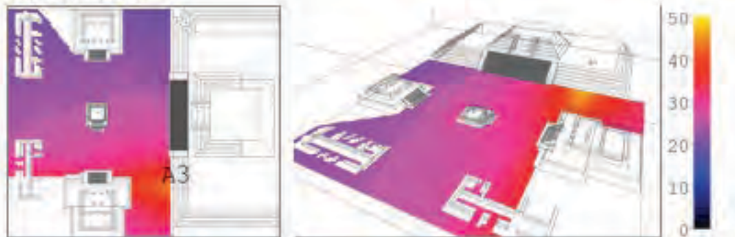
Fig. 5.21 "Mapeo de nivel de presión sonora, simulación de voz en fuente A3". Elaboración propia, 2014.
