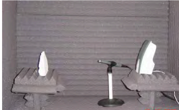
Fig. 1.6 "Medición de estuco en cámara sonoamortiguada". Fuente: Zalaquett, 2006.
