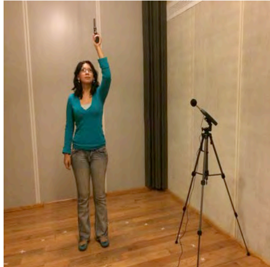
Fig. 4.6 “Medición de ruido de impulso en el LADAc de la UAM-A”. Elaboración propia, 2014.
