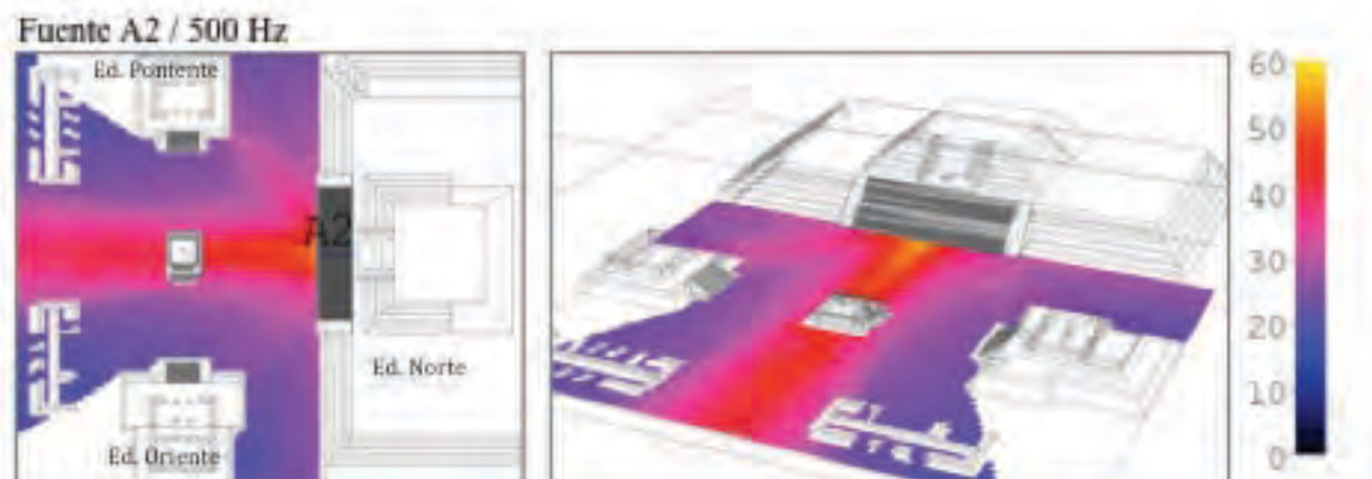
Fig. 6.2 “Mapeo de intensidad sonora de fuente A2 en 500 Hz, CATT Acoustic”. Elaboración propia, 2016.
