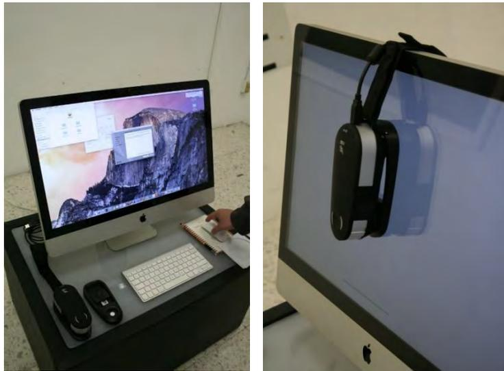
**Figura 62.** Calibración del color mediante espectrofotómetro.
