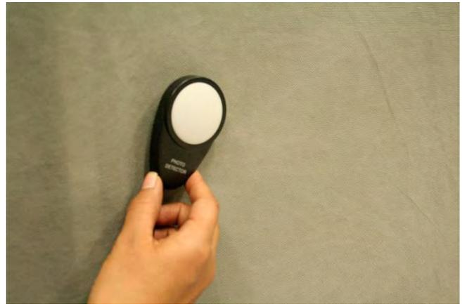
Luxómetro marca STEREN para medición de iluminancia de laboratorio.
