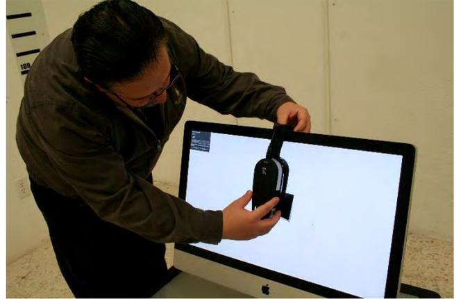
Espectrofotómetro marca X-Ray para calibración de color en pantalla.
