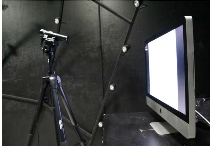
**Figura 63** Colocación de equipo de medición de luminancia en pantalla
