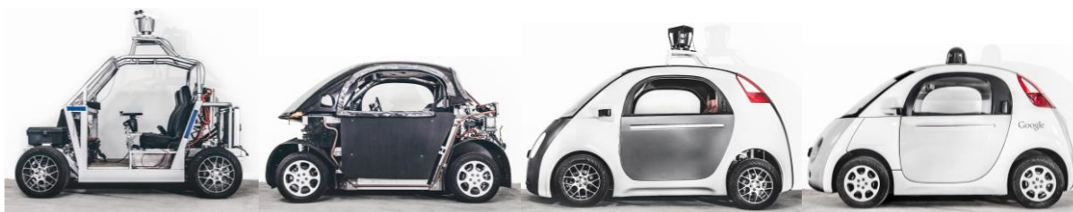
Figura 45. Firefly, vehículo autónomo prototipo de Google (2013). Diferentes estadios del proyecto: “Engineering mule”, “Uncle mule”, “Beautified Mule” y prototipo final (52).
