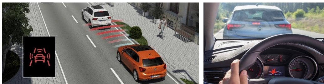
Figura 32. City Emergency Braking (42) | AEB urbano/interurbano con alerta de colisión (45)
