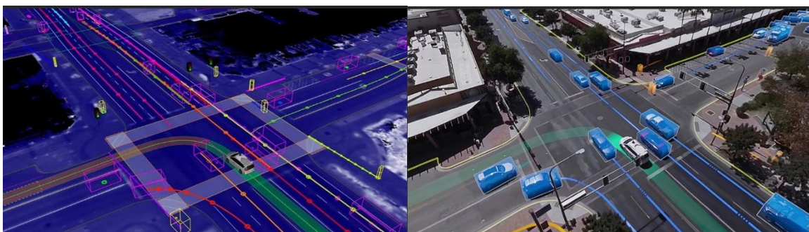
Figura 51. Interpretación del sistema Waymo del entorno y superposición sobre el entorno real (60).
