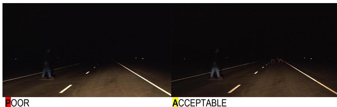
Figura 110. Evaluación de iluminación en IIHS: pobre vs aceptable (28)
