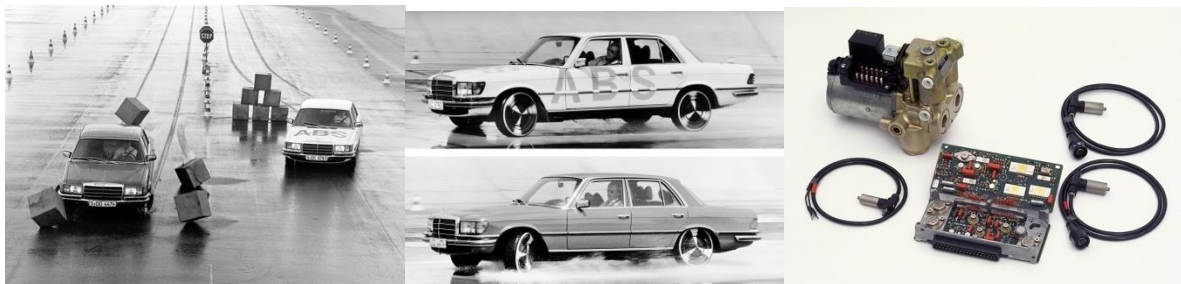
Figura 28. ABS: comparativas de frenado con y sin sistema, clase S, generación 116; componentes del ABS (37).
