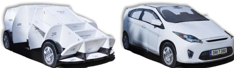
Figura 95. GVT- Vehículo objetivo global, vehículo simulado para pruebas ADAS (94)
