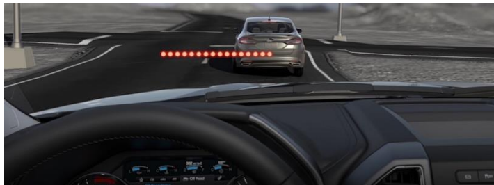
Figura 31. FCW: alerta de colisión frontal
