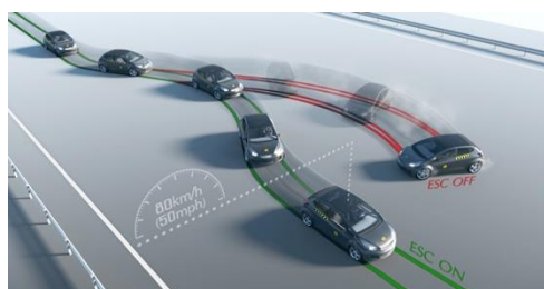
Figura 92. Evaluación Euro NCAP de seguridad activa: ESC(93)
