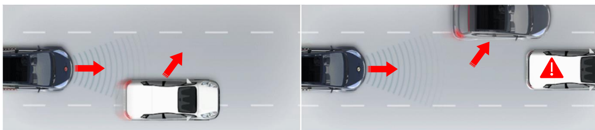
Figura 103. AEB escenarios cut-in y cut-out (29)
