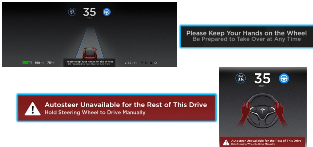
Figura 42. Arriba. Cuadro de instrumentos durante la conducción con autopilot y recordatorio de manos al volante | Abajo. Advertencia de desconexión de Autopilot (50).
