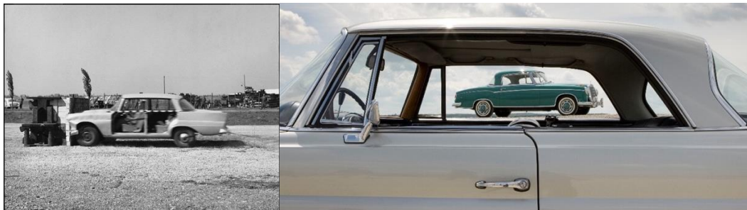
Figura 16. Primer crash test realizado por Mercedes-Benz, 10 septiembre 1959 colisión frontal contra barrera rígida, vehículo de la serie W111, Mercedes 220 (1959 - 1968). (14)
