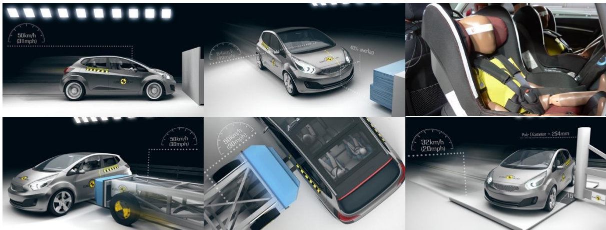
Figura 89. Evaluación Euro NCAP de seguridad pasiva: impactos (93)
