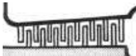
Figura 61. Geometría de varios escalonamientos en una turbomáquina.
