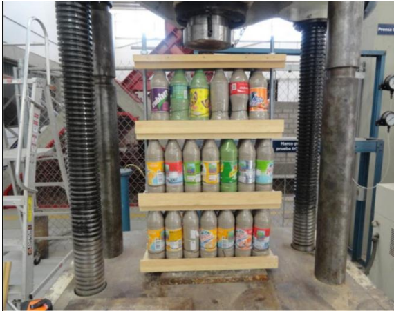
Figura 1: Prueba compresión, tomado de (Espinosa-Guzmán, 2016)
