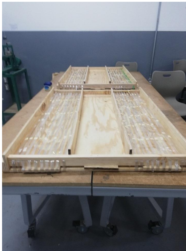
Figura 18: Montado de paquetes de tiras PET sobre cimbra.
