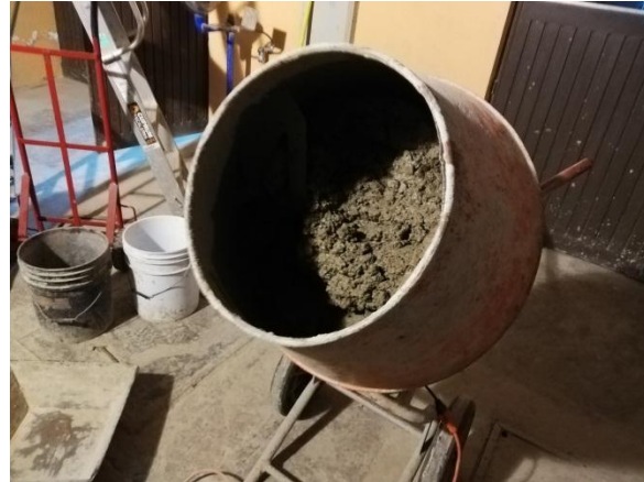
Figura 38: Revolvedora para colado placas
