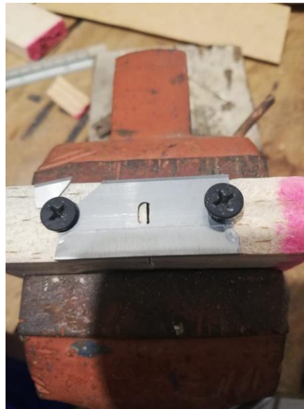
Figura 14: Rotura de navaja por exceso de tensión
