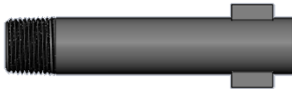
Figura 4.7 Tubo pasantes. Elaboración propia.
