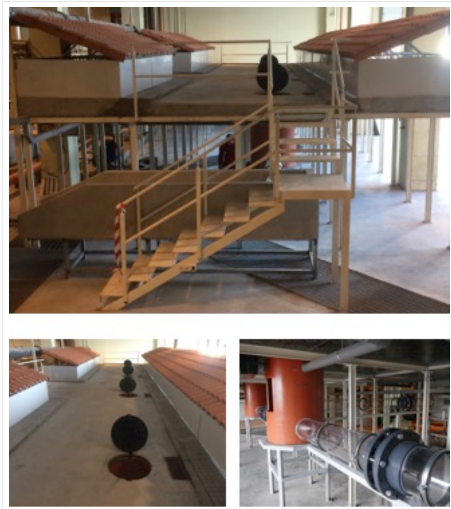
Figura 4. Vista general de la PCEHU (arriba) y superficie y red drenaje del modelo físico (abajo).
