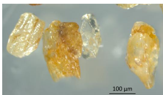
a) fração retida na peneira 0,6 mm
