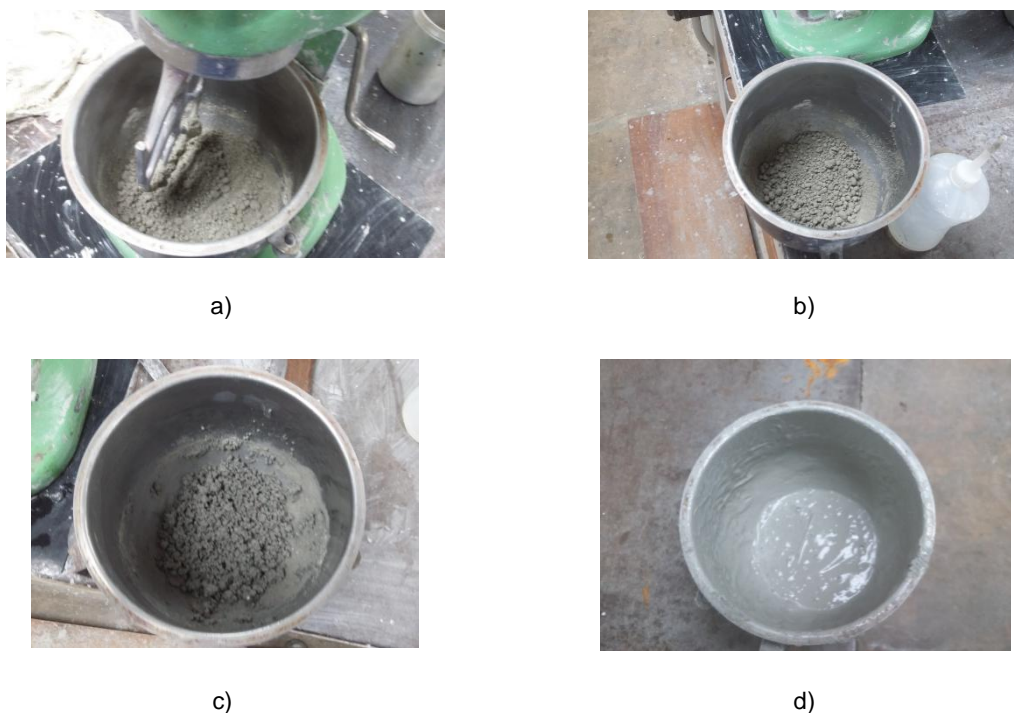
Figura 23: fases do empacotamento do cimento a) estado seco; b) estado pendular; c) estado funicular; d) estado capilar
