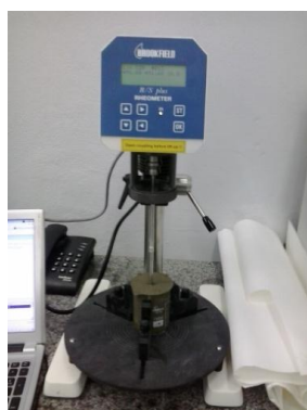
Figura 25: Reômetro Brookfield R/S plus pertencente ao Laboratório de Materiais e Tecnologia do Ambiente Construído (LAMTAC) do NORIE/UFRGS
