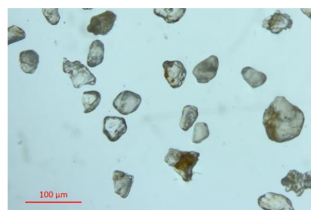
b) fração retida na peneira 0,3 mm
