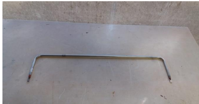
Figura 15 - Resistencia Blindada 500W.
