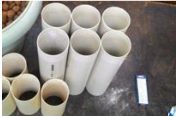
Figura 7 - Corte de los caños de PVC.
