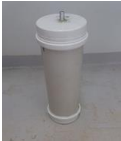
Figura 14 - Reactor de PVC completo.
