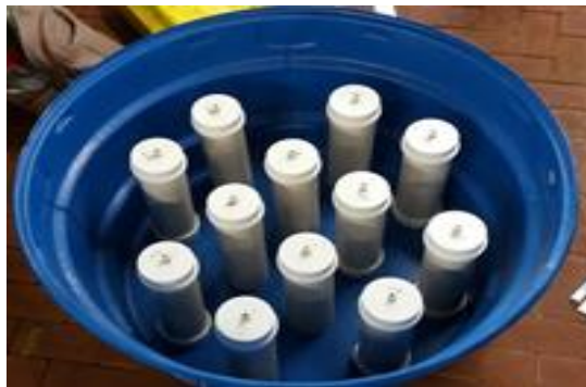
Figura 29 - Gasómetros "modelando" dentro del depósito.
