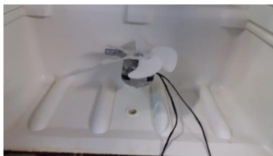
Figura 19 - Instalación del ventilador.
