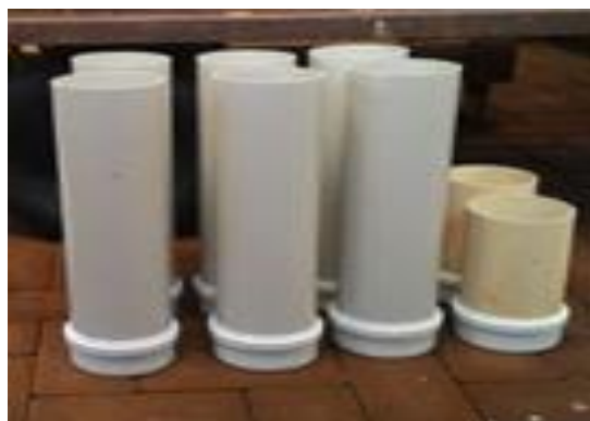
Figura 8 - Sellado de las CAP en la base de los reactores.
