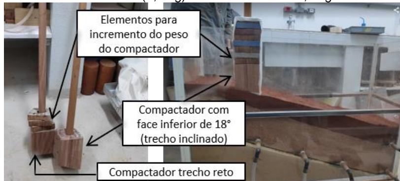
Figura 28. Dispositivos compactadores. O peso dos compactadores (1,3 kg) mais elementos de incremento (2,4 kg) totalizou cerca de 3,7 kg.
