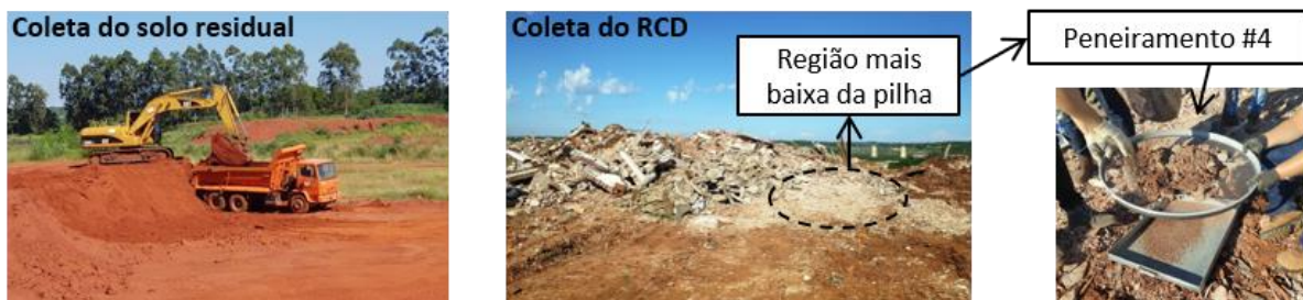
Figura 6. Coleta dos materiais utilizados para o trabalho no ARSU de Foz do Iguaçu.
