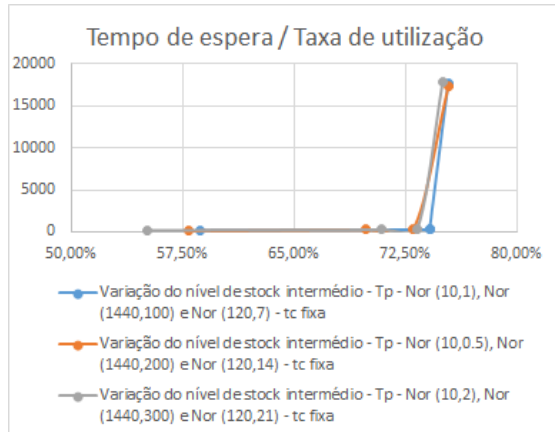
Figura 5.107: Modelo 3 - Cenário 1 - Gráfico do tempo de espera médio dos tanques do tipo A em função da taxa de utilização média de todas as máquinas/servidores que realizam operação nesse tipo de material.
