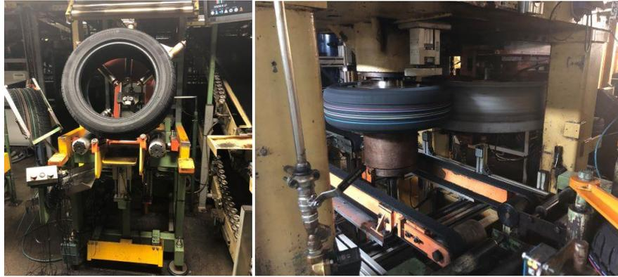
Figura 10 – Departamento V – Inspeção Final. Esquerda: Inspeção Visual. Direita: Uniformidade.
