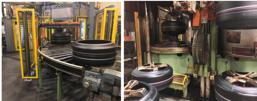
Figura 9 – Departamento IV – Vulcanização. Esquerda: Cabine de pintura. Direita: Prensa.
