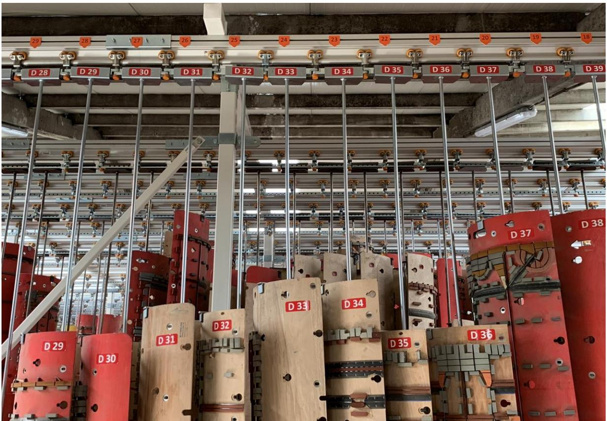
Figura 32 - Identificação dos ferros de suporte e moldes do cortante rotativo.
