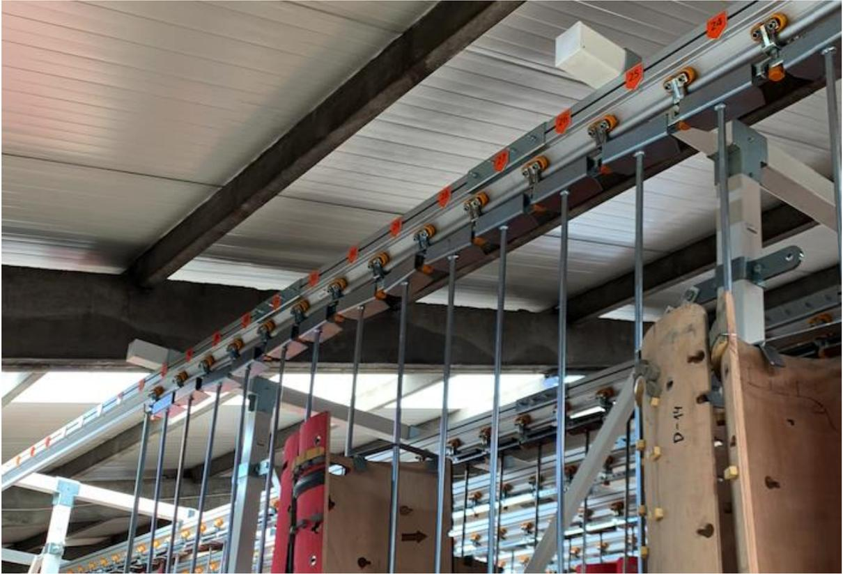
Figura 31 - Colocação de etiquetas sobre a calha livre para identificação da posição de armazenamento de cada cortante.
