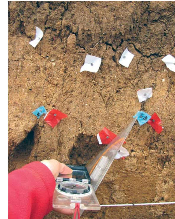
Medição da atitude (direção e inclinação) de um plano de falha com o auxílio de uma bússola de geólogo.
