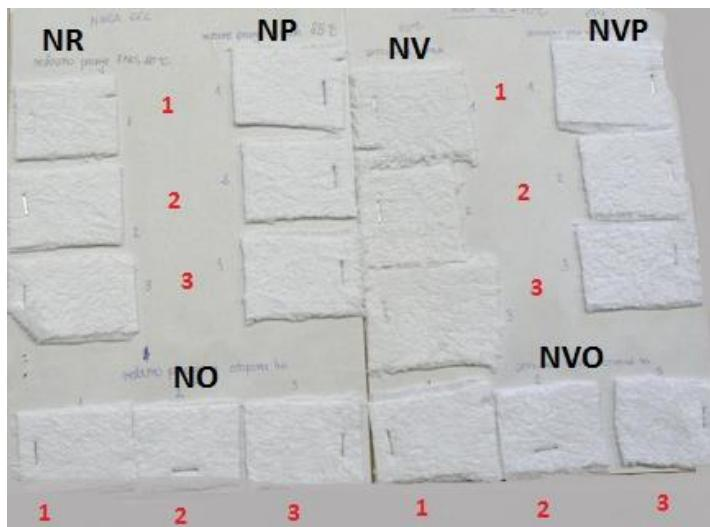
**Slika 2:** Uzorci ručnika sa zaprljanjima na bazi polikvaternija nakon pranja u: destiliranoj vodi (NV); destiliranoj vodi i naknadnoj obradi natrijevim ditionitom u prahu (NVP); destiliranoj vodi i naknadnoj obradi u inoviranoj otopini natrijevog ditionita (NVO); deterdžentom (NR); deterdžentom i naknadnoj obradi natrijevim ditionitom u prahu (NP); deterdžentom i naknadnoj obradi inoviranoj otopinom natrijevog ditionita na 20°C (NO)
