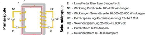
Bild 2: Prinzipskizze – Aufbau einer Zündspule [3]
