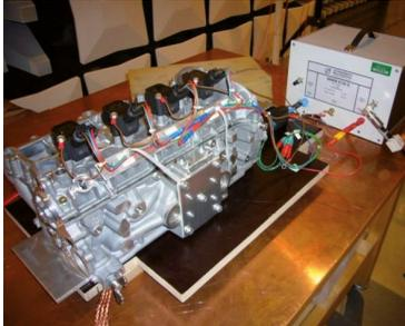
durch die geometrischen Gegebenheiten nur für Kompakt-Zündspulen geeignet. Die Abbildung zeigt den Messaufbau für leitungsgebundene Störaussendungsuntersuchungen. In Abwandlung – längerer Leitungssatz – wird dieser Aufbau auch für gestrahlte Störaussendungsanalysen verwendet. Die Ergebnisse bei leitungsgebundenen Emissionsmessungen sind dabei messaufbauunabhängig und nicht relevant für den Korrelationsvergleich.
