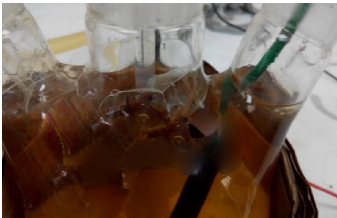
Figura N°14: Burbujas en la cámara anódica.
