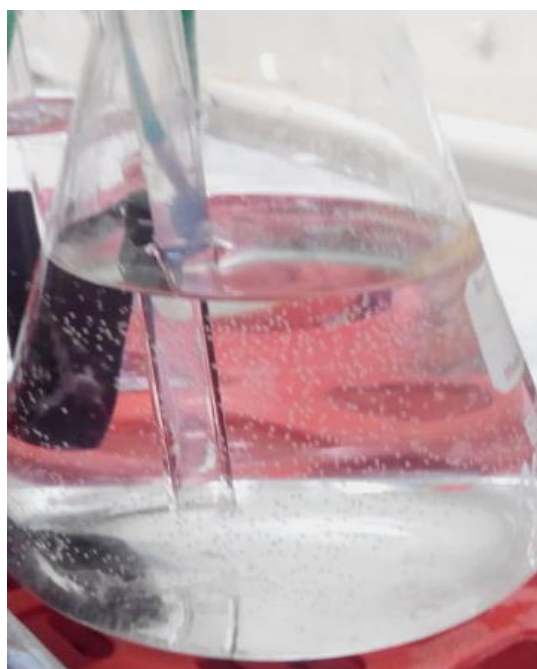
Figura N° 12: Burbujeo en la cámara catódica
