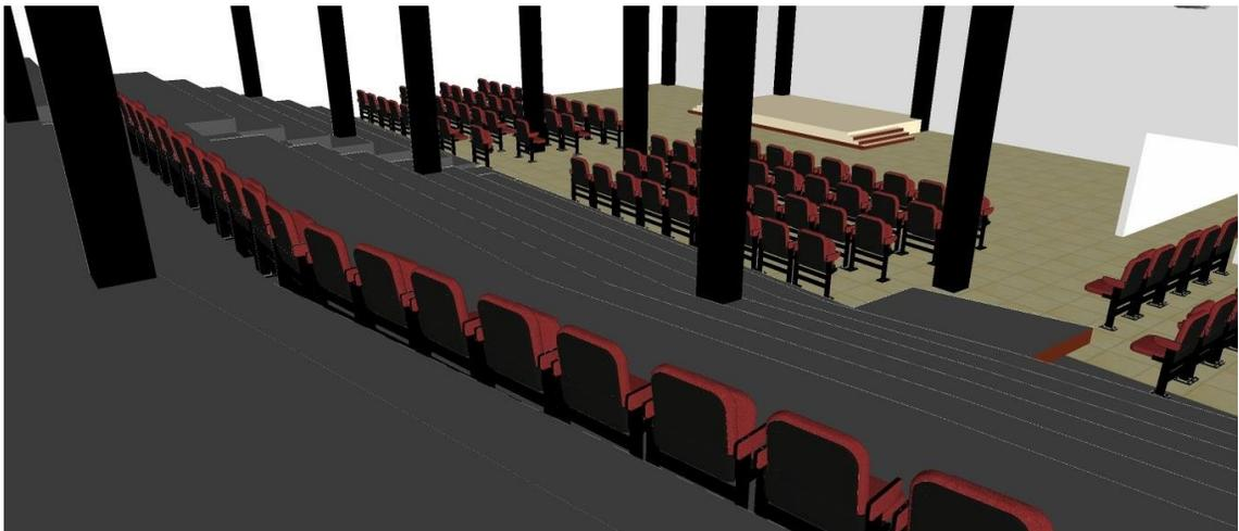
Sea agrega más filas de gradas a la estructura del lado izquierdo en total incrementa 3 metros de ancho en la estructura de las gradas agregando de igual forma butacas en la parte de en medio de la infraestructura.
