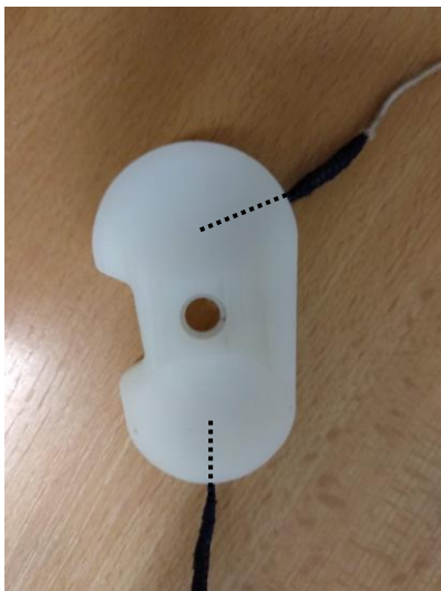
Obrázek 27: Umístění termočlánků v tibiální vložce
