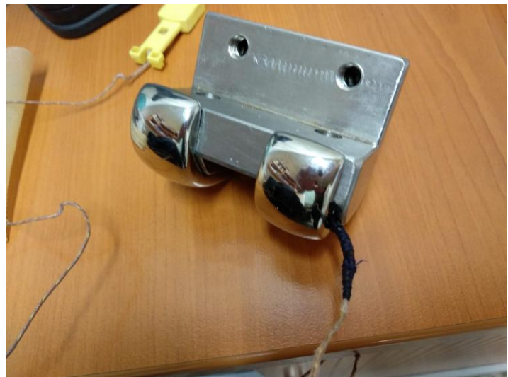
Obrázek 28: Umístění termočlánku mezi femorální komponentu a upínací nástavec
