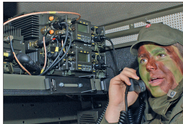
2. ábra. Rádiós gépkocsiba épített, információvédett beszéd- és adatkommunikációra alkalmas FUS-96E rádiókészlet
