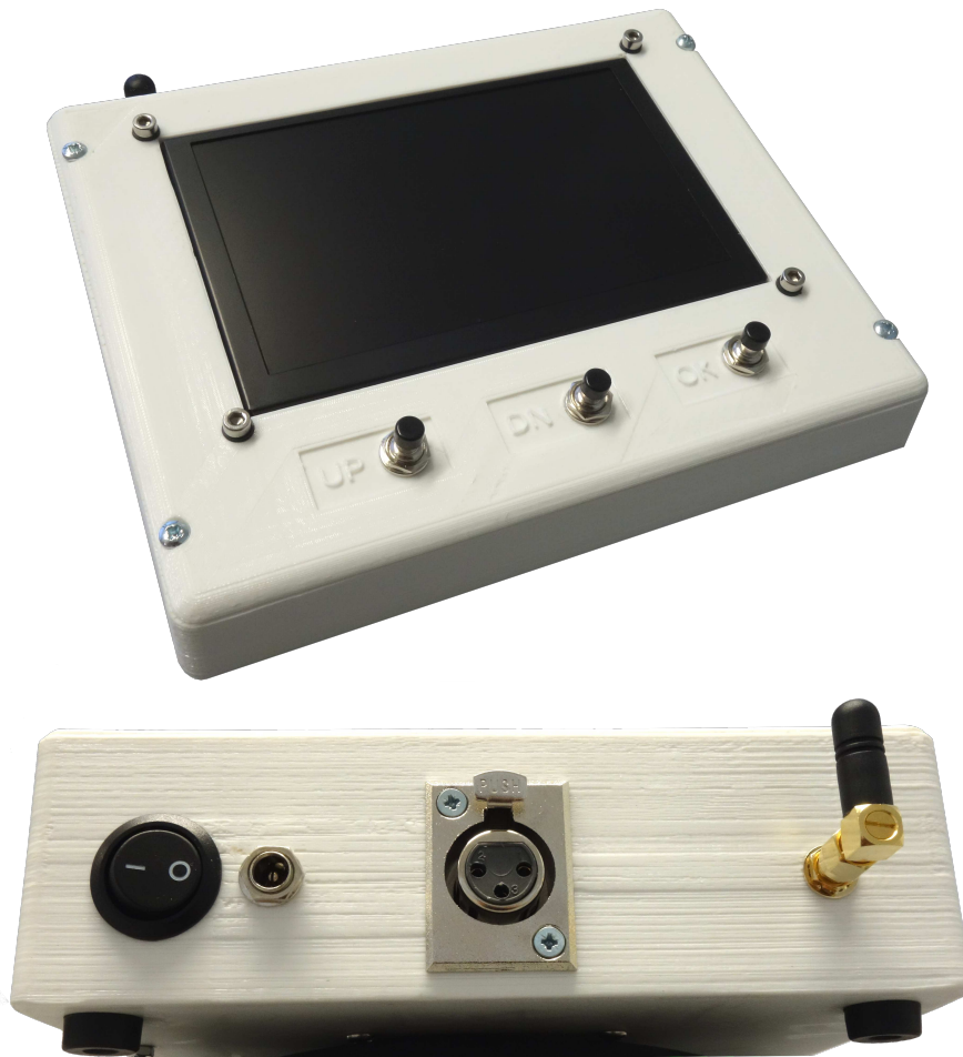
Abbildung 57: Oben: Gefertigte, geschlossene Basisstation aus perspektivischer, vorderer Ansicht. Unten: Rückseite der gefertigten Basisstation.
