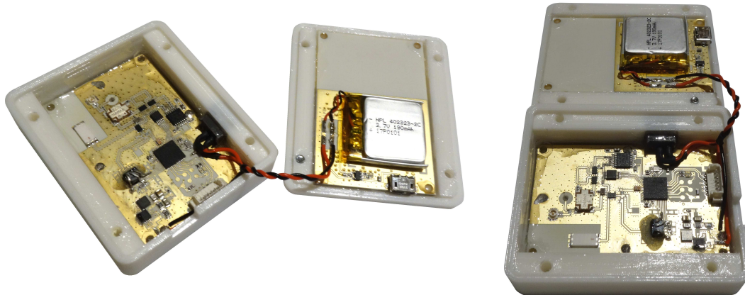
Abbildung 53: Unterschiedliche Ansichten des zweiteiligen Aufbaus einer Mobileinheit. In der Gehäuseunterseite befindet sich der Verbund aus Sensor- und Messschaltungsplatine, in der Gehäuseoberseite die Versorgungsplatine. Der Betriebsspannungsschalter und die interne Verdrahtung komplettieren die Einheit.
