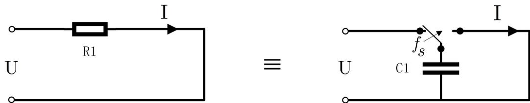
**Abbildung 74: Äquivalenz von geschalteter Kapazität und ohmschem Widerstand**
