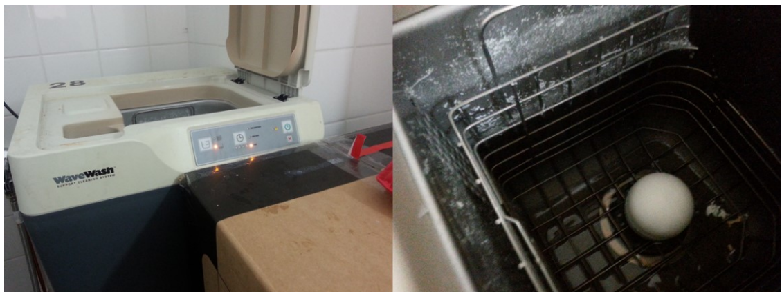
Kuva 19. Tukirakenteiden liuottamiseen käytetty pesukone..
