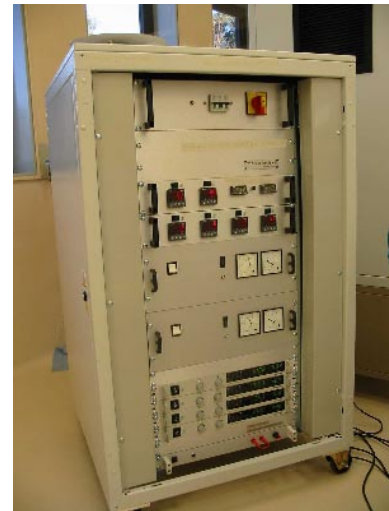
Figura 8: Simulador solar; fuentes de alimentación y sistemas de control.
