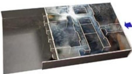
Fig 5 Ensayo en Túnel de Viento. Dirección del flujo De aire perpendicular a la fachada.
