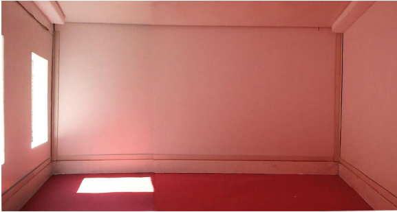
Figura 13: Prototipo con iluminación unilateral, ventanas al Norte, Julio a las 12:00 h.
