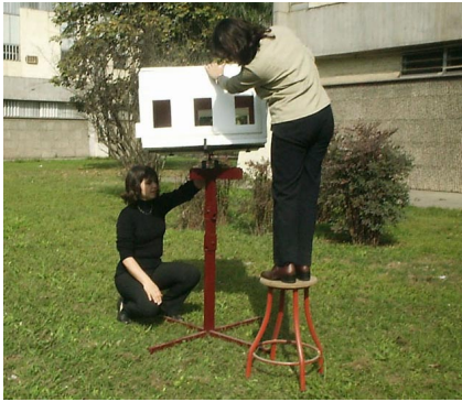
Figura 2: Verificación de asoleamiento
