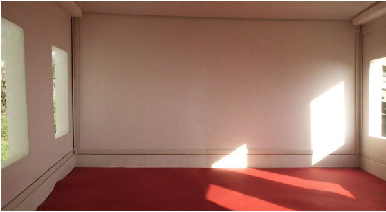
Figura 5: Prototipos base con iluminación bilateral, ventanas al norte, cielo claro, Julio 10:00 h.
