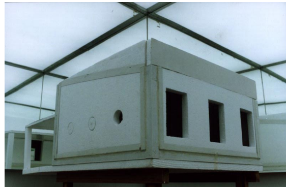
Figura 3: Mediciones en cielo Artificial
