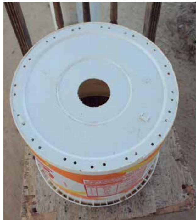
Balde do biofiltro com furos de 2 mm ao redor, espaçados a cada 2 cm. Os furos são utilizados para prender as cordas desfiadas que formam a cabeleira
