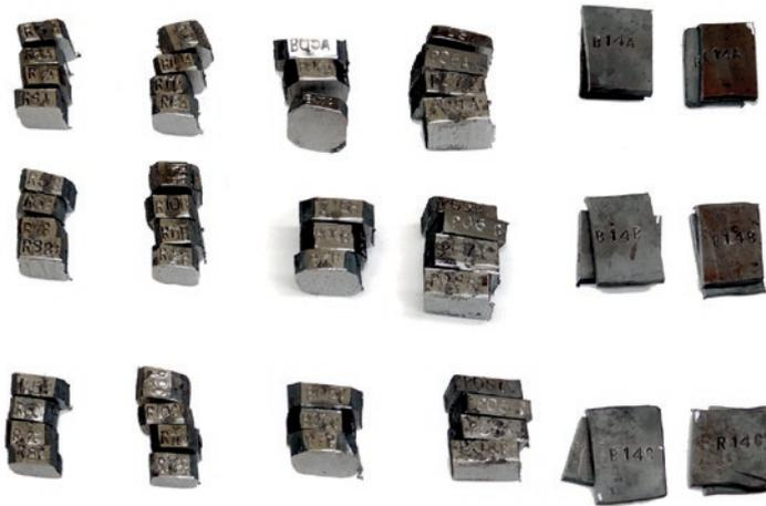
Abb. 80: Aufsagen der aufgekohlten Barren zur Probengewinnung. Oben: Beispiel: Probe B05: Drei dickere Probensegmente zu ca. 11 mm wurden unterschiedlich gehärtet und dienten den Härtemessungen; drei dünnere Proben zu ca. 5 mm wurden mit dem Mikrotom zerlegt für die Kohlenstoff- und Schwefelanalysen. M. 1:3. – Unten: Alle Härtemessungs-Proben vor dem Einbetten, Polieren und Analysieren.
