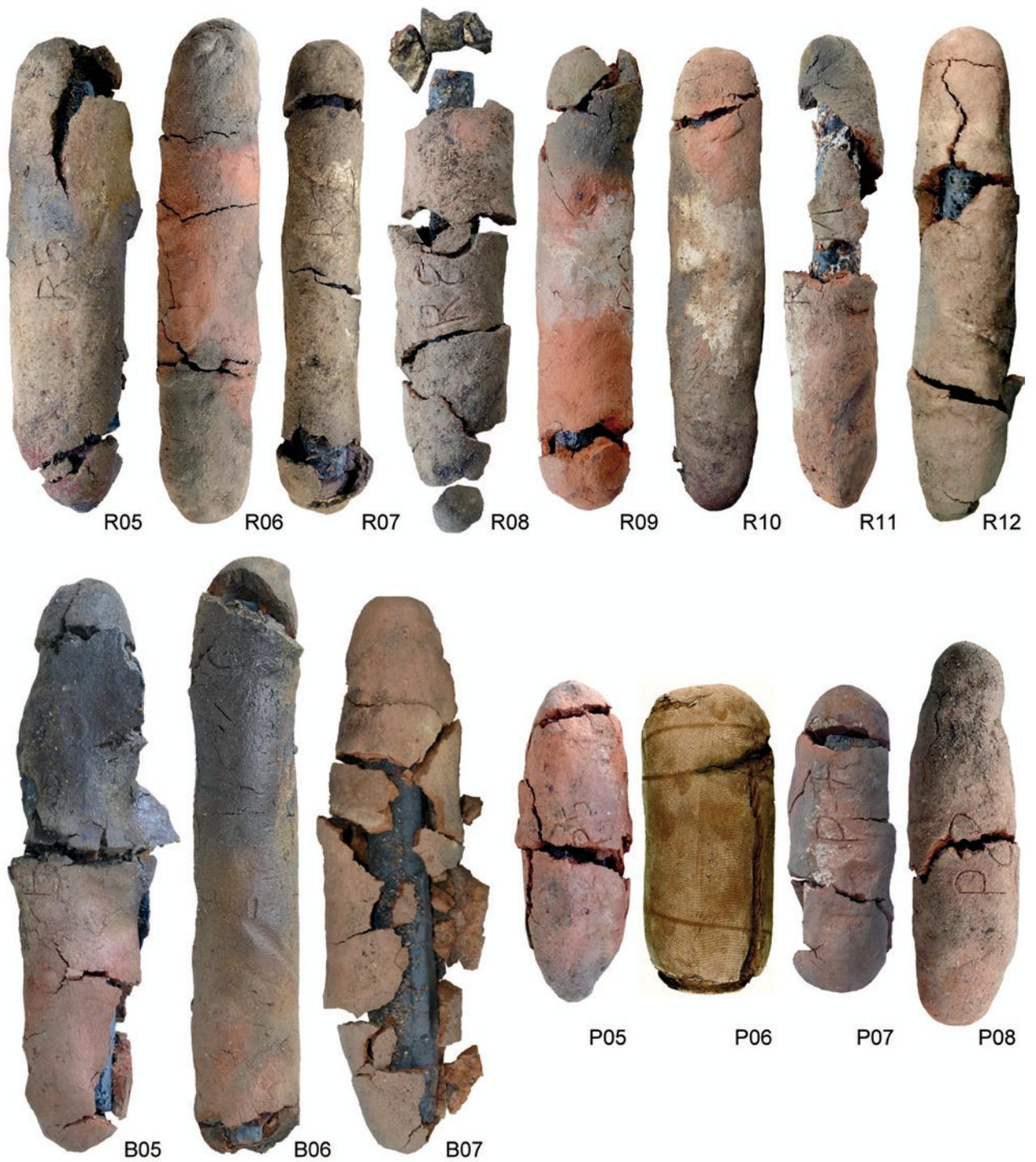
Abb. 76: Aufkohlungsexperimente in Lehmumhüllungen: Die Lehm Pakete nach dem Einsatz im Zementationsfeuer (Barreninhalt: Abb. 61). Obere Reihe: R05–R12; untere Reihe: R05–R07 und P05–P08. – P06 ist separat im Elektroofen gebrannt worden. – Dieselben Objekte vor dem Brand: Abb. 72. – M. 1:3.
