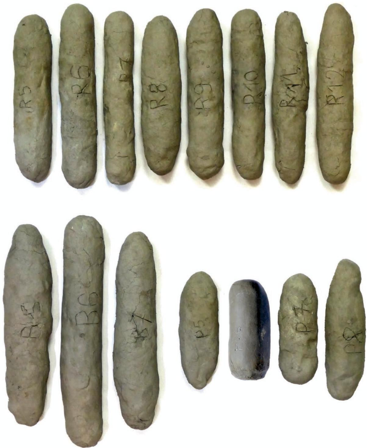
Abb. 72: Aufkohlungsexperimente in Lehmumhüllungen: Die fertigen, getrockneten Lehmpakete vor dem Einsatz im Feuer (Barreninhalt: Abb. 61).
