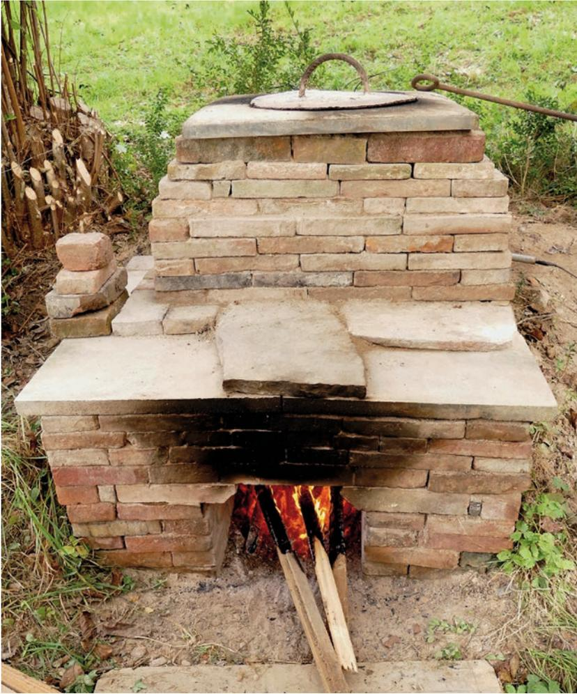
Abb. 73: Aufkohlungsexperimente in Lehmumhüllungen: Der zur Zementation (der mit organischen Materialien und Lehm umhüllten Eisenbarren) verwendete Brennofen. Er ist aus Ziegelsteinen und wenigen Schamottesteinen (an strategisch heiklen Stellen) trocken gemauert (ohne Lehm); die Hohlräume zwischen den Bausteinen sind zur Isolation mit Asche zugestopft. Den Brennraum selbst bildet ein eingebauter Eisenblechzylinder von 40 cm Durchmesser (Abb. 74). Gefeuert wurde mit dünn gespaltenem Tannenholz.
