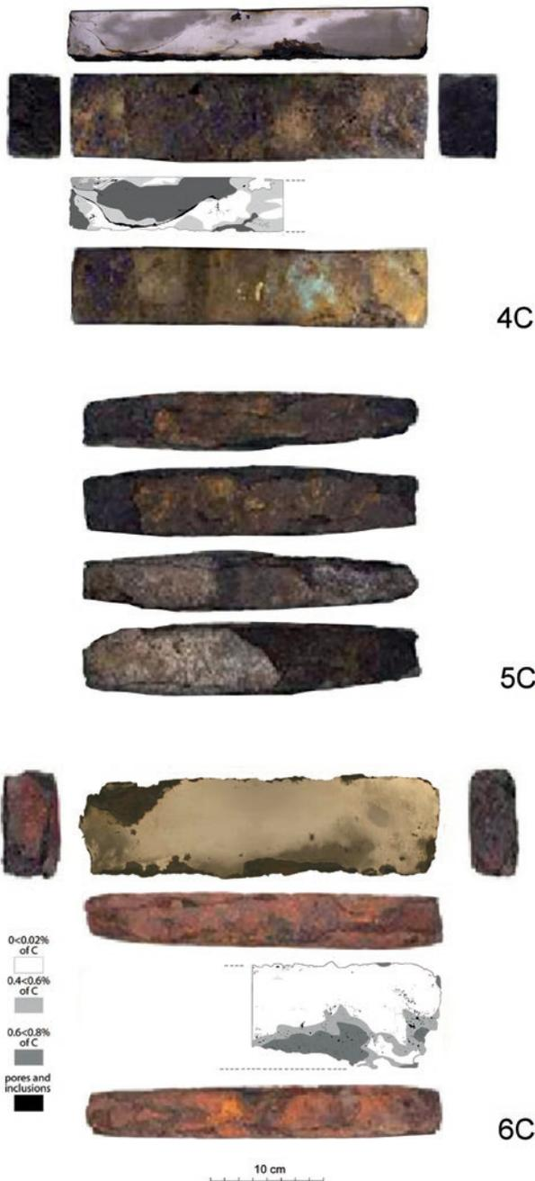
Abb. 45: *Saintes-Maries-de-la-Mer* / F. Drei (kurze) Beispiele zahlreicher Eisenbarren aus römischen Schiffswracks (Fotos und Schnitte mit Angaben der Kohlenstoffgehalte). Sie weisen im Innern zwar kohlenstoffreichere Zonen auf, sind aber nicht durch Zementation oberflächlich aufgekohlt. Beispiele der langen Varianten siehe Abb. 46. M. 1:6.
