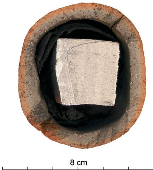
Abb. 78: Die aufgeschnittene Lehmumhüllung mit dem Barren P06 nach dem geglückten Brand. Man beachte den rot reduzierenden Brand aussen und den schwarz reduzierenden innen. M. 1:1.
