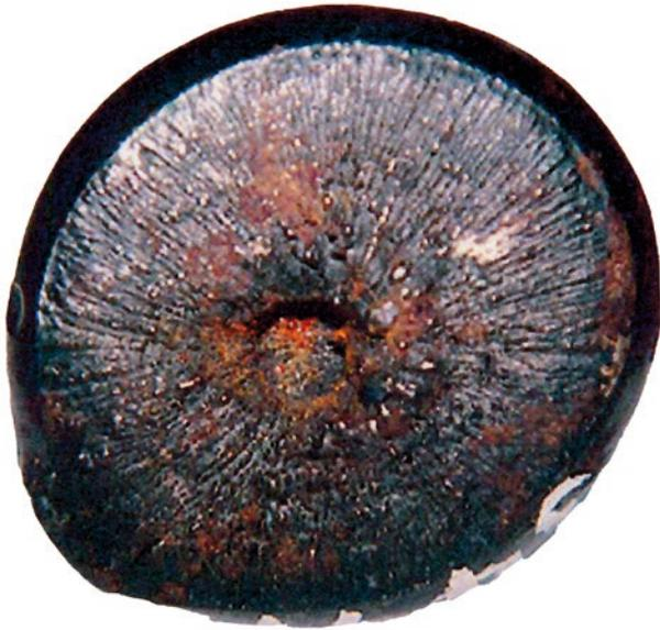
Abb. 23: Zylinderförmiger Barren aus dem indisch-asiatischen Tiegelstahlprozess im Science Museum, London / GB. Die Eisen-Kohlenstoff-Schmelze in hohen röhrenförmigen Tiegeln (Abb. 22) führte zu einem homogenen Stahlbarren, und beim langsamen Abkühlen und Erstarren bildeten sich auf dessen Oberfläche radiale Erstarrungsstrukturen. Ohne Massstab.
