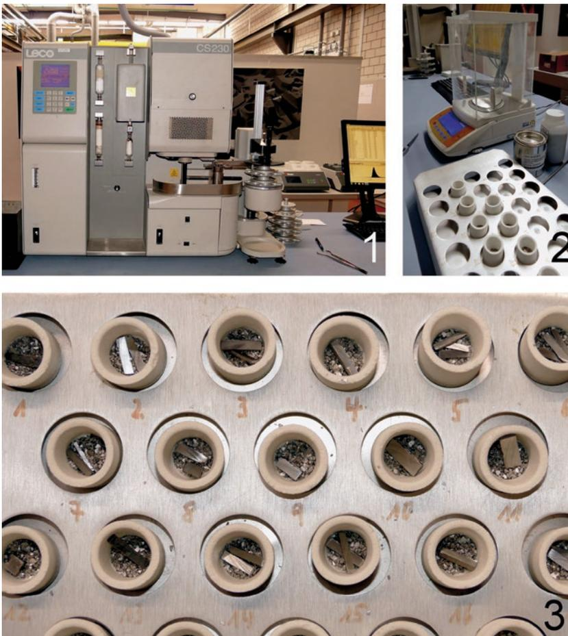
Abb. 111: Analyse der Kohlenstoff- und Schwefelgehalte. 1 = Analyseautomat «LECO, CS230», 2 = hoch hitzebeständige Proben Tiegelchen vor der Feinwaage (1/1000 Gramm), bereit zum Einwägen der individuellen Probengewichte (0,6 bis 1,5 g), 3 = kleine Proben-«Streifchen», aus den Barren (Abb. 81) mit dem Mikrotom aus verschiedenen Positionen im Barrenquerschnitt herausgeschnitten.
