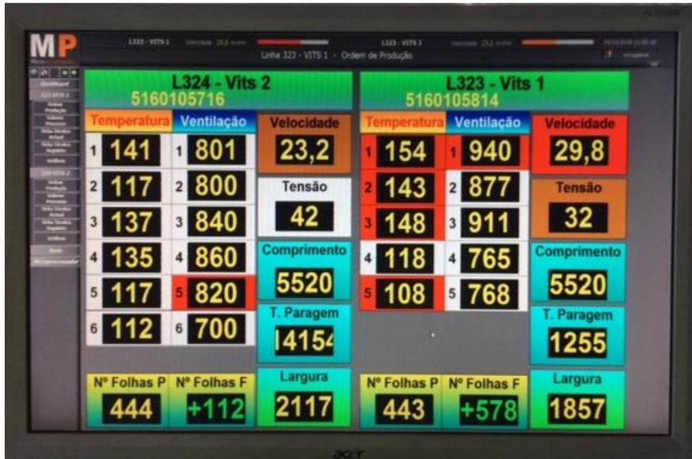
Figura 4-11: Sistema ANDON para controlo dos parâmetros de processo.
