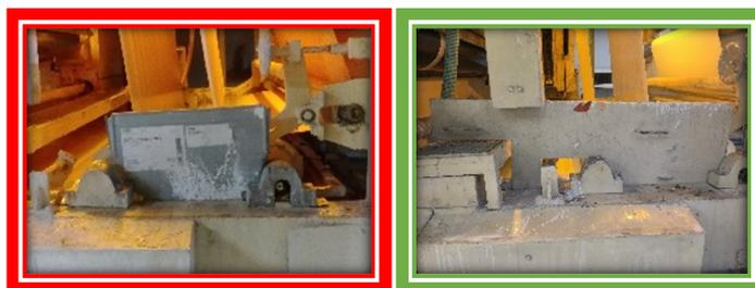
Figura 4-4: Substituição de peças maquinadas por peças originais e da marca do equipamento.
