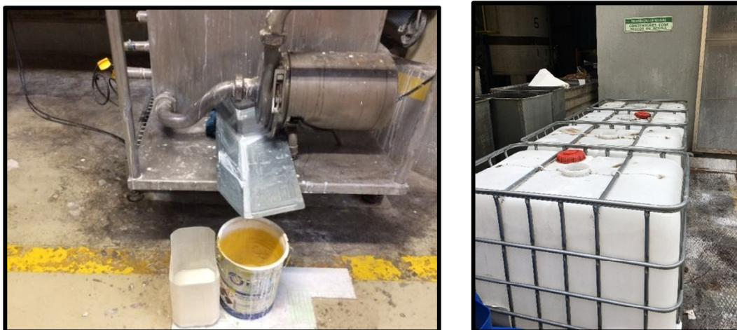
Figura 4-8: À Direita: Desperdício de resina por consequência de fuga no sistema de bombagem À Esquerda: Local de armazenamento do excedente de resina.
