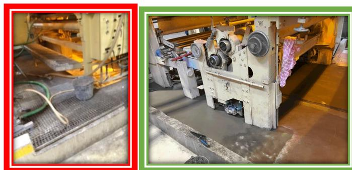
Figura 4-3: Alteração da zona de limpeza dos banhos de resina (de plástico para uma rampa).
