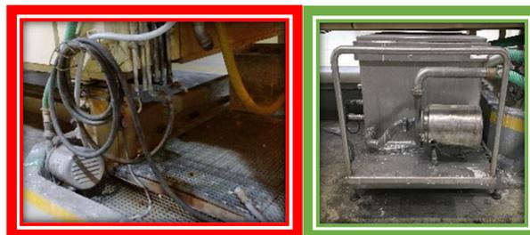
Figura 4-2: Alteração do tanque de *coating* para diminuir o respetivo tempo de limpeza.
