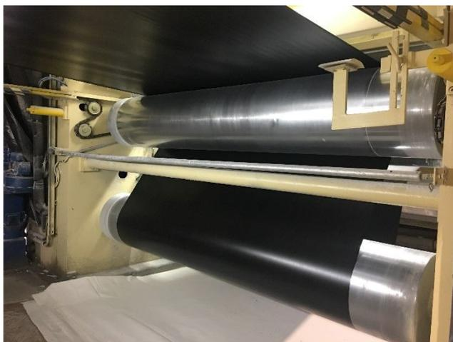
Figura 1-10. Esquema representativo dos rolos arrefecedores. Fonte: Sonae Arauco e autor
