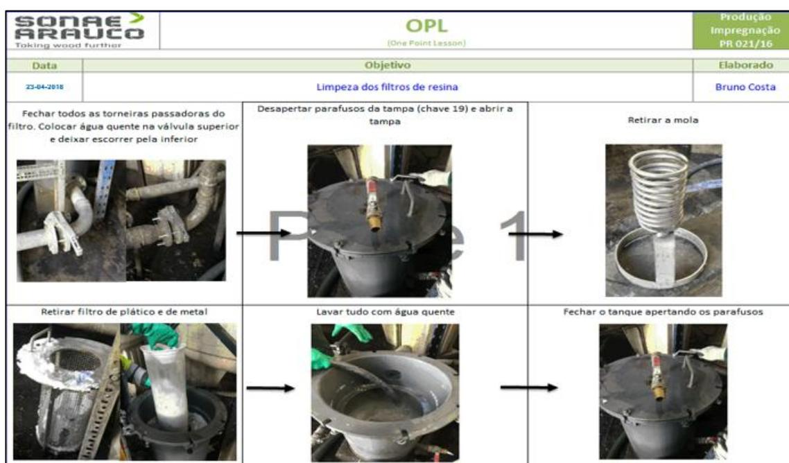
Figura 4-13: Procedimento de limpeza de filtros
