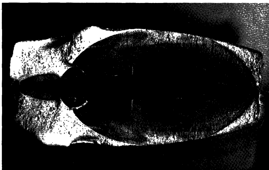
Fig. 12 - Fissure localisée relevée à la suite d'essais destructifs sur éprouvette apparemment non rompue à 2 millions de cycles. L'amorce intérieure s'est propagée jusqu'à la surface extérieure du tube.
