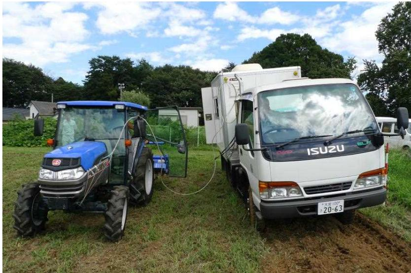
図 2-8 供試トラクタ（左）とほ場排出ガス測定車（右）
