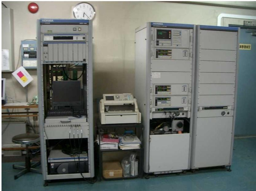
図 2-11 自動車排出ガス測定装置
