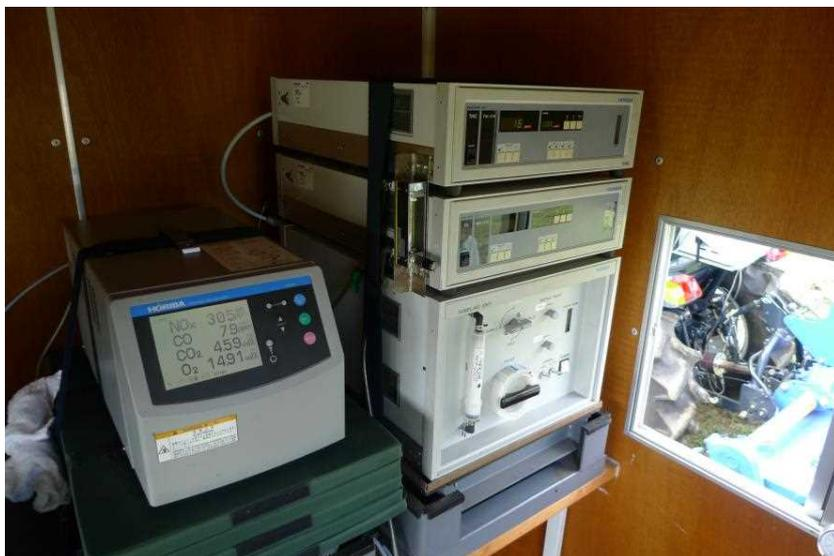
図 2-9 排出ガス分析計（左）と排出ガス分析計ユニット（右上段）
