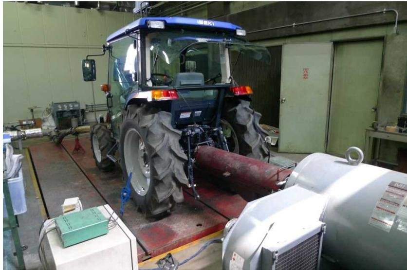
図 2-6 試験の様子（供試トラクタと動力計）
