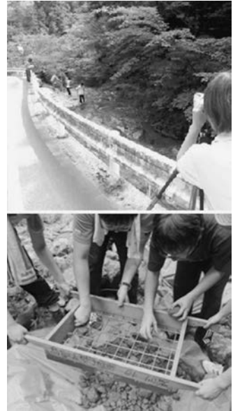
図5 現地調査の風景 上：平面・横断測量 下：粒度分析
