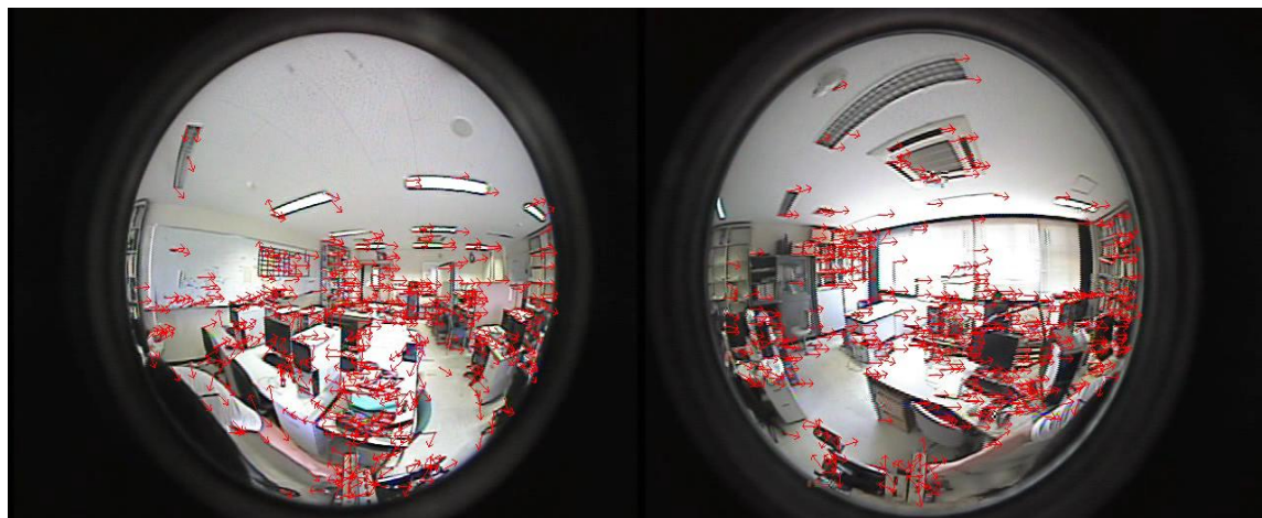
図 3.11 全天周画像シーケンスで特徴点の移動方向は KF により予測する．各特徴点の移動過程で各の予測方向を持っている．
