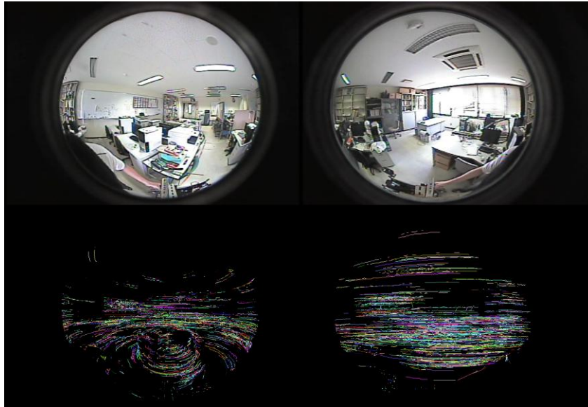
図 3.8 提案手法により全天周画像シーケンスの特徴点追跡の出力. 異なる特徴点の軌跡が異なる色で示される.
