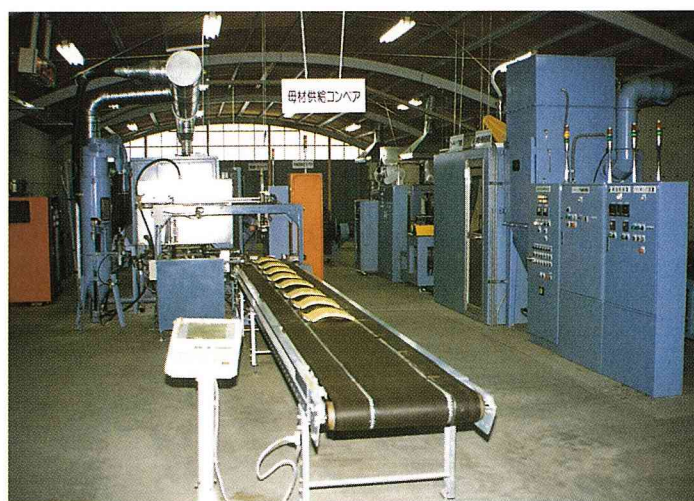
図1.2.1 融雪瓦生産システムの全景
