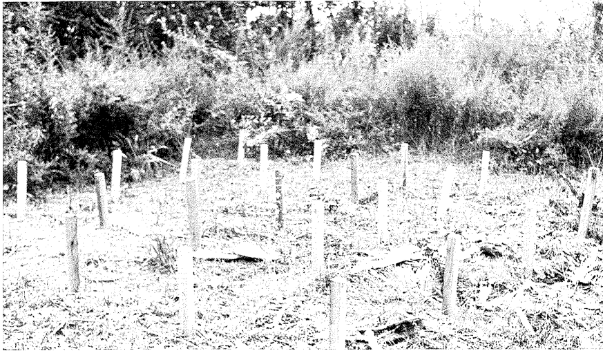
写真2 学内苗畑での野外杭試験
