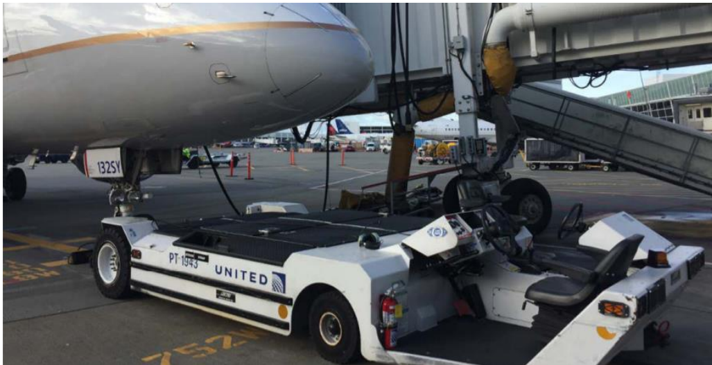
Slika 5. Vozilo za vuču zrakoplova koje koristi United Airlines pokretano na električnu energiju
