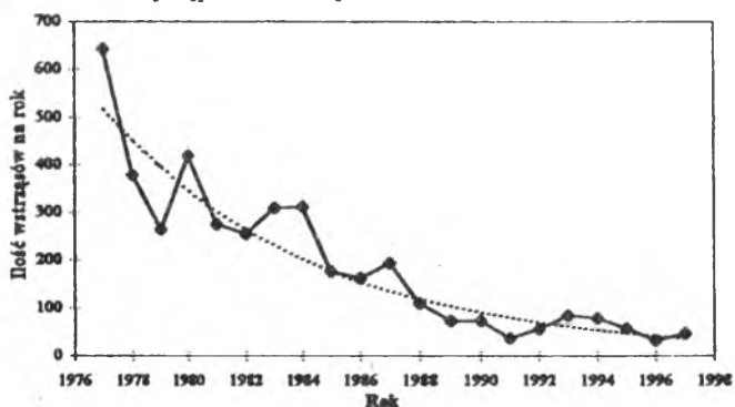
Rys. 2. Wykres średniej rocznej aktywności sejsmicznej GZW dla wstrząsów o energii większej od 1 MJ w latach 1977-1997 (wg: Idziak, Teper, Zuberek, 1999).
